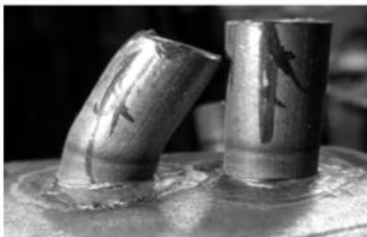
Рис. 3. Вигин шипа при ударному навантаженні.
