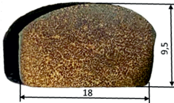
Рис. 1. Шліф досліджуваного виливка із сірого чавуну з 3,94 % С та 2,59 % Si після травлення в пікраті натрію.
