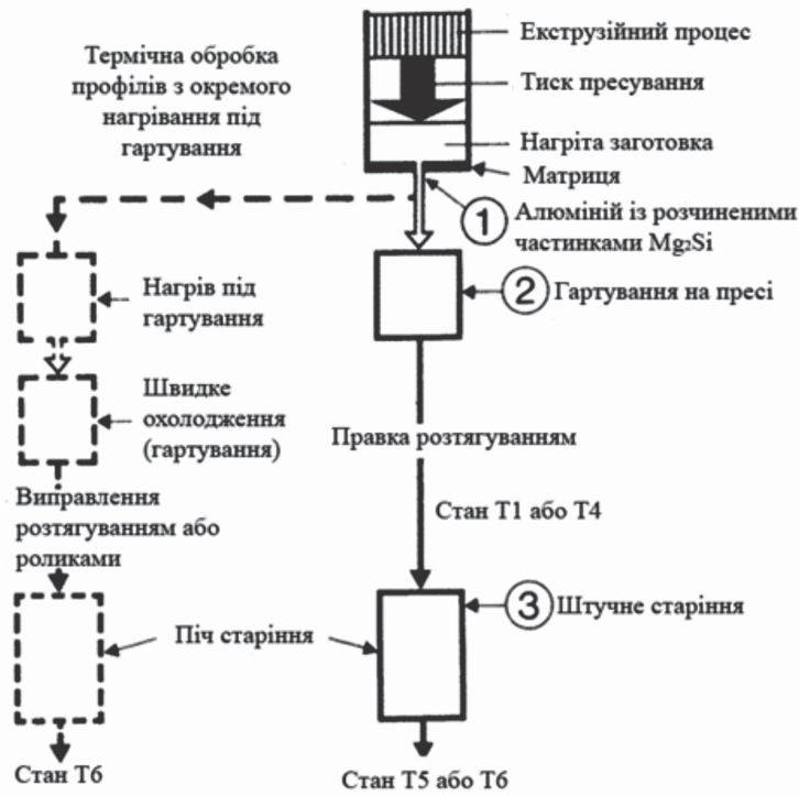
Рис. 1. Стадії термічного зміцнення алюмінієвих профілів на пресі [1].
