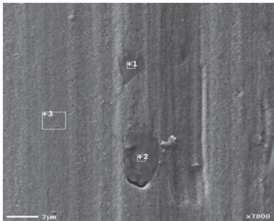
Рис. 5. Поверхня зразка сталі після тертя та після іонного травлення, з вказаними ділянками зйомки Оже спектрів, x7000.
