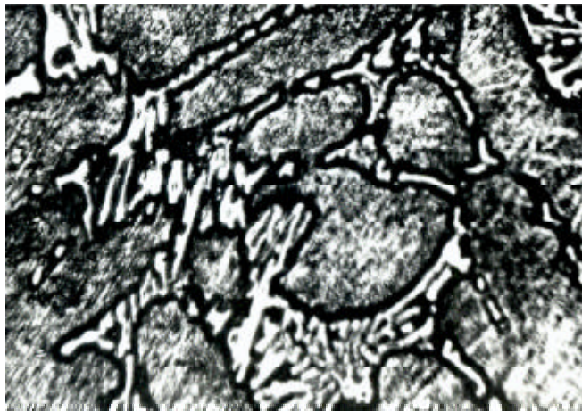
Рис. 2. Мікроструктура дослідного чавуну після нагріву до 650°C та витримки 10 год. × 800.
