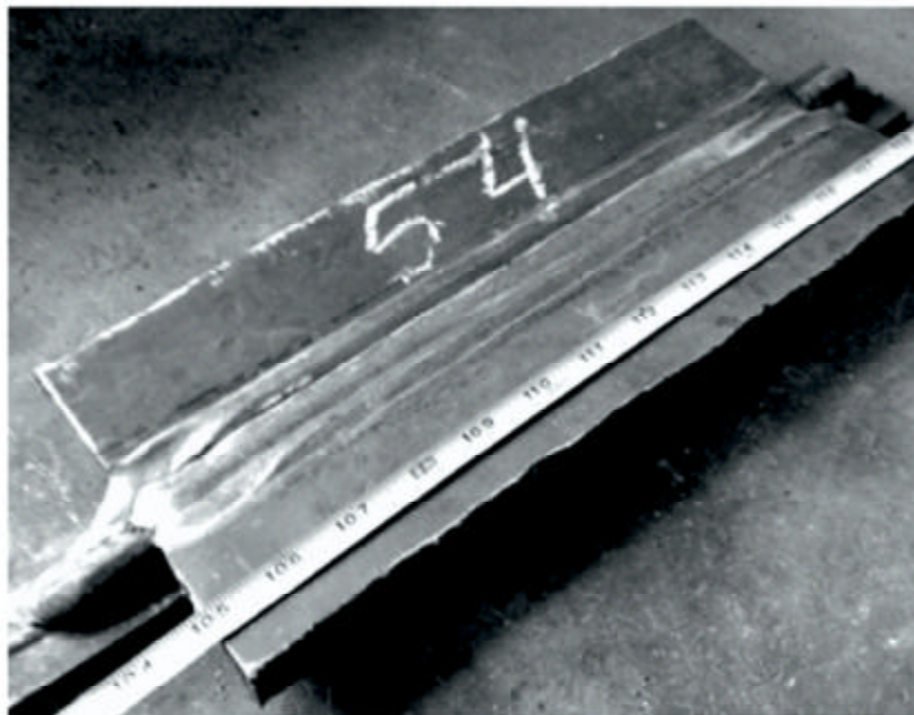
Рис. 1. Зразок зварного з'єднання сталі 09Г2.
