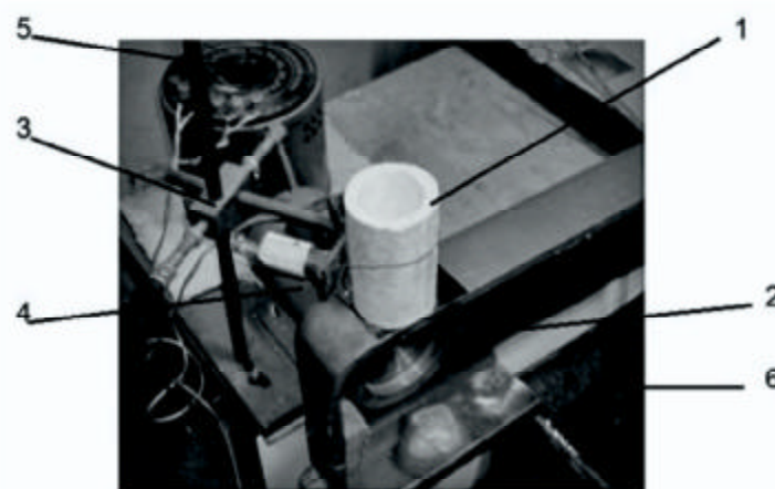
Рис. 1. Установки для отримання дрібнокристалічних лігатур, 1 – приймальна воронка для подачі розплаву, 2 – мідний диск-кристалізатор, 3 – пристрій для регулювання зазору, 4 – електродвигун, 5 – система керування електродвигуном; 6 – приймальна ємність.
